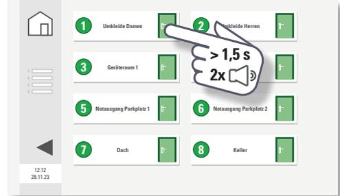
Um eine einzelne Tür in den Daueröffnungsmodus zu versetzen, drücken Sie das Türsymbol ca. 2 Sekunden lang. Wenn die Tür entriegelt ist, ertönen zwei kurze Pieptöne. Die Anzeige des Türsymbols ändert sich.
