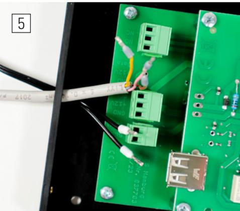
Die benötigten Kabel durch die Kabeleinführung ziehen.
